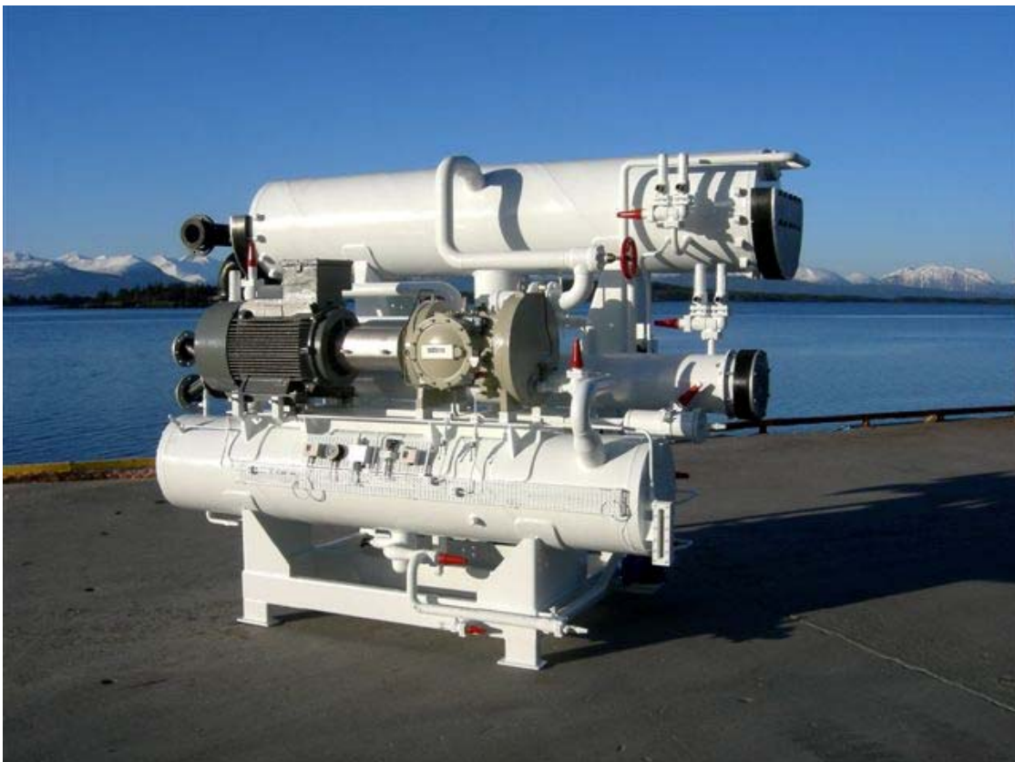
Figur 32: Tilsvarende Aquaterm anlegg med skruekompressor, [Vedlegg 16].
