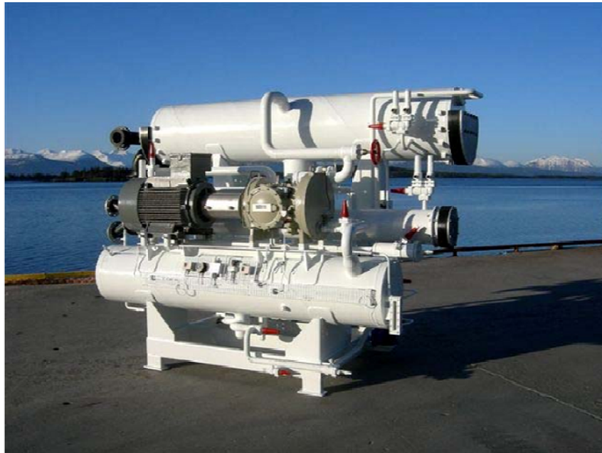
Bilde av tilsvarende anlegg med skruekompressor.
