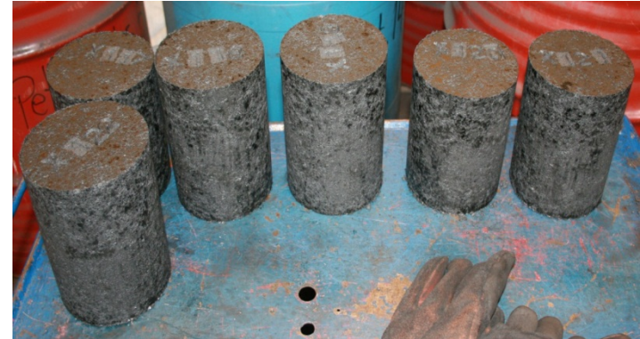
Anode-diameter 13 cm, høyde 17–18 cm
